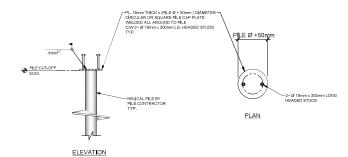
DETAIL - PILE CAP PLATE
